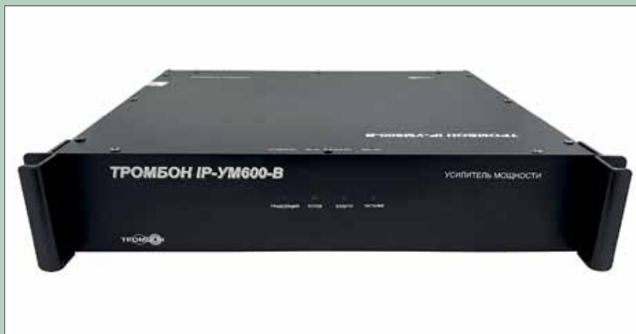
Фото 1. Установка горизонтально, в 19" стойку или телекоммуникационный шкаф
