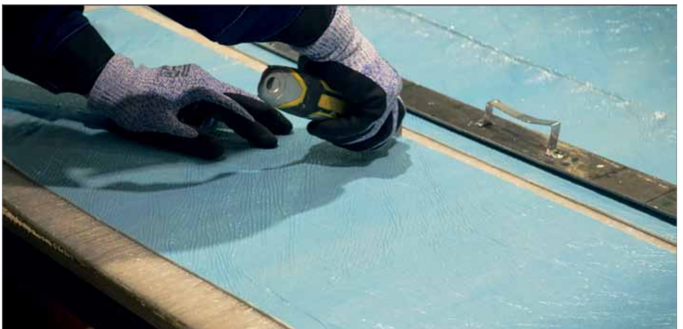
Фото 4. Подготовка SMC-композита к формовке
