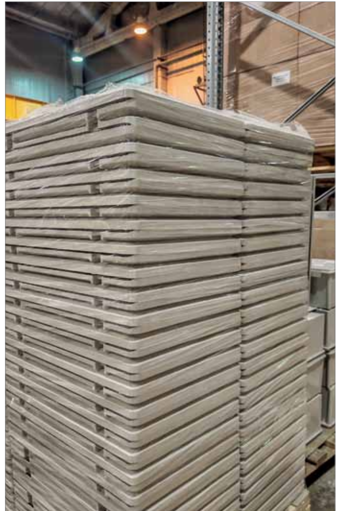
Фото 8. Детали монтажных шкафов из SMC- композита, готовые к сборке
